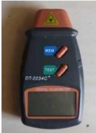
Gambar 2. Tachometer jenis DT 2234C
