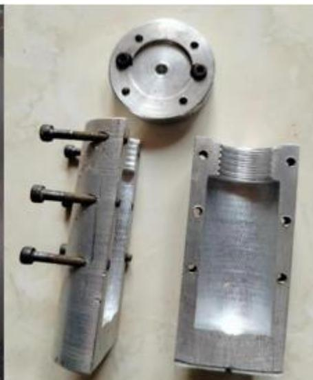
Gambar 4. Proses Pembentukan Inti Botol 30ml (core)
