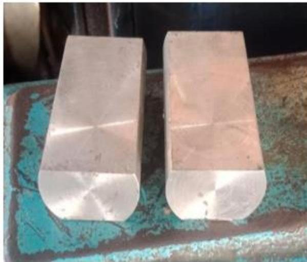
Gambar 2. Meratakan Dimensi Cetakan Menggunakan Prosedur Miling Datar
