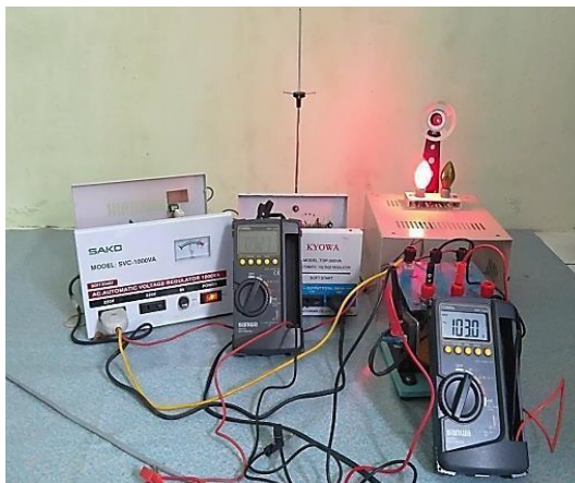
Gambar 9. Hasil Pengujian tegangan input AC dan output DC pada penyearah (Dioda Bridge)
