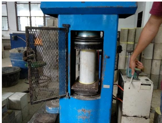
Gambar 9 Pengujian Kuat Tekan Beton Sumber: Penelitian Laboratorium, 2018
