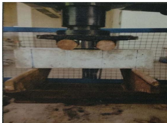
Gambar 13. Pengujian Kuat Lentur Beton Sumber: Penelitian Laboratorium, 2018
