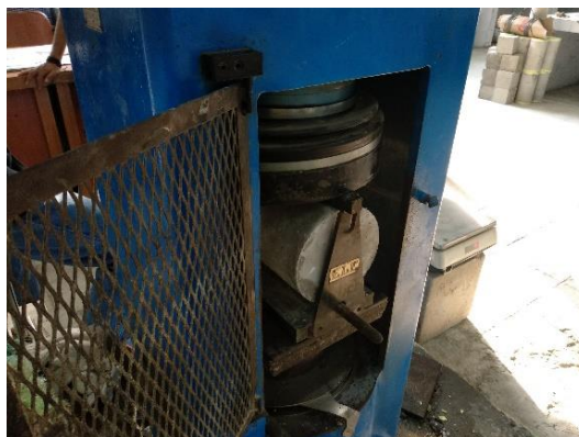
Gambar 11. Pengujian Kuat Tarik Beton Sumber: Penelitian Laboratorium, 2018
